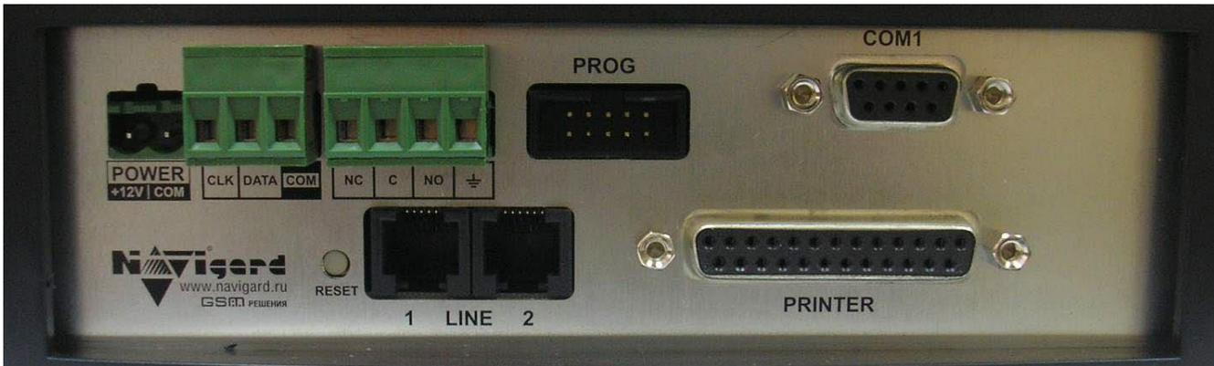
Рис. 8. Проводной приемник NV DT 3220. Вид сзади.
